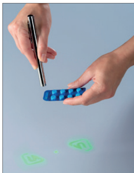
Identifikation eines versteckten Logos mit einem Laserpointer.
