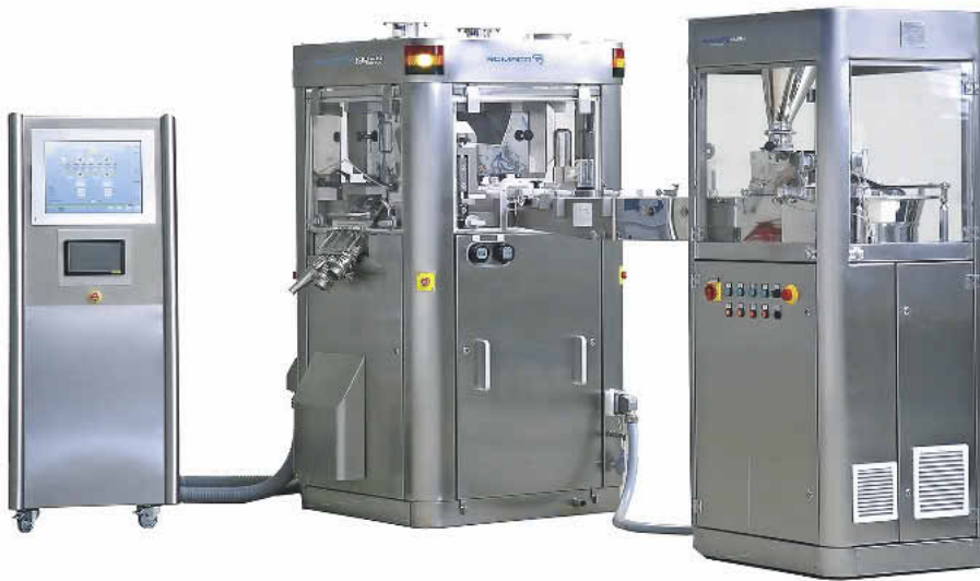
Die Synthesis TTH ist eine Hightechpresse zur Produktion von Mantelkerntabletten
