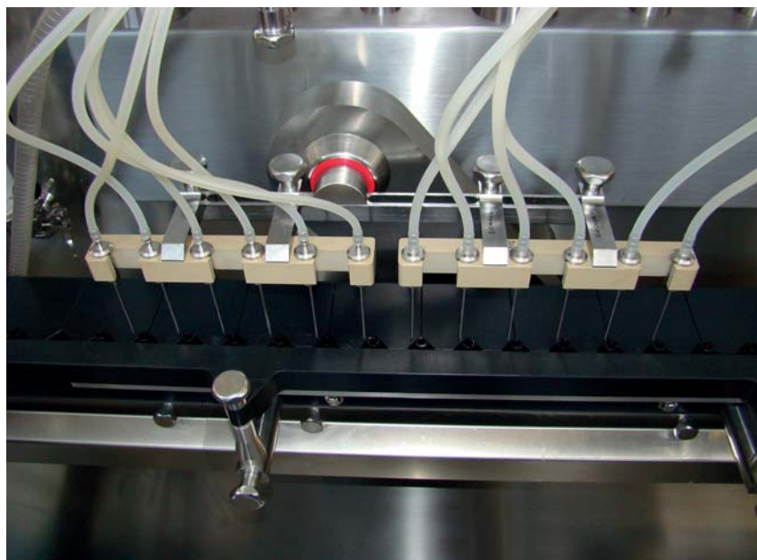
Zwangsgeführter Fläschchentransport zu den einzelnen Abfüllstationen.
