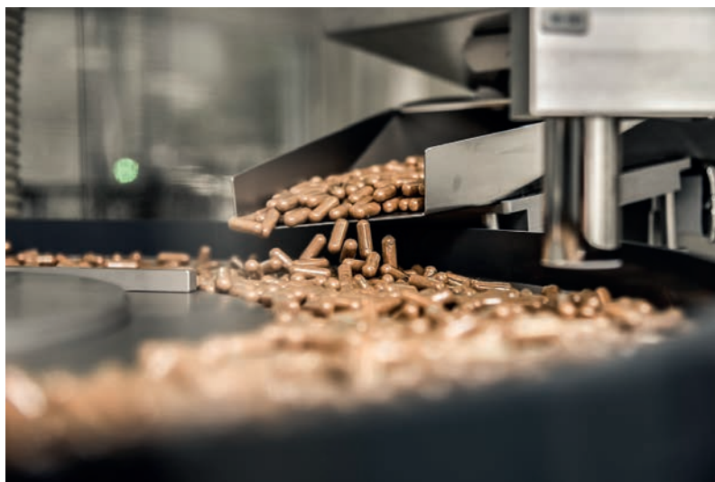
Alimentación de cápsulas de muchas hierbas medicinales de PADMA en la máquina de blíster de Romaco Noack.
