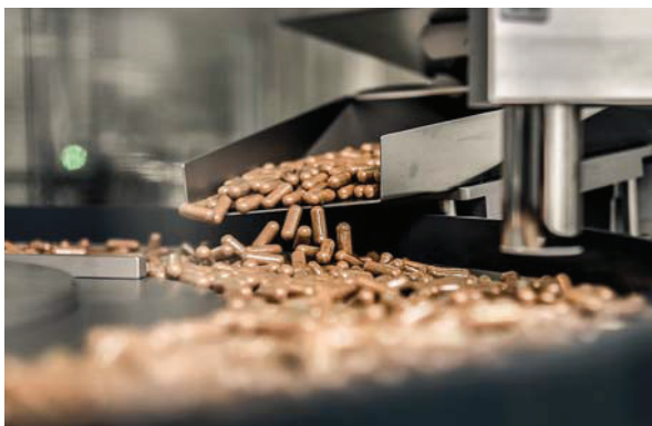
Zuführung der Vielkräuterkapseln in die Blistermaschine von Romaco Noack. (Bilder: PADMA AG, 2016, Wetzikon, Schweiz; Fotograf: Hans Schubert)
