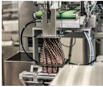
In einem starren Wendeschacht werden die Blister vor der Abstapelung um 90 Grad gedreht.
