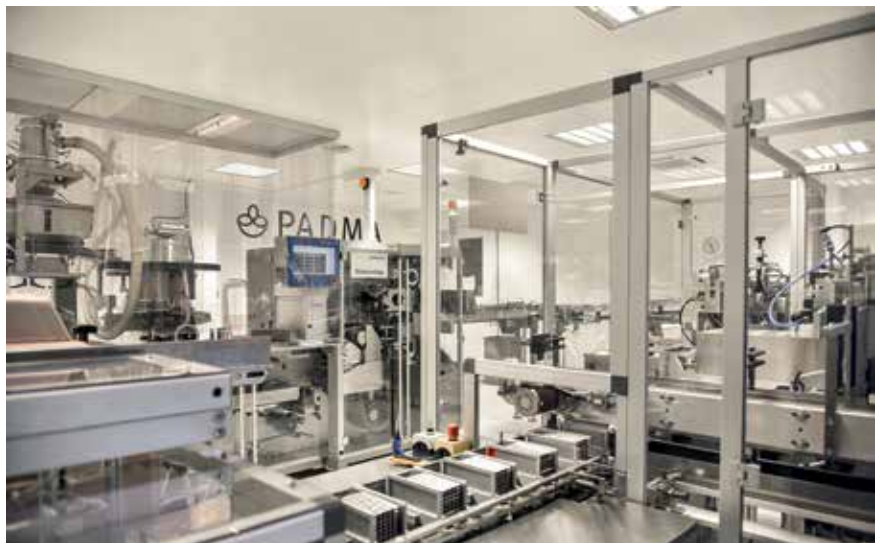
Padma hat sich für eine Blistermaschine Noack 921 mit dem getakteten Horizontalkartonierer Promatic P 91L und dem Sammelpacker Promatic PAK 100 entschieden.
