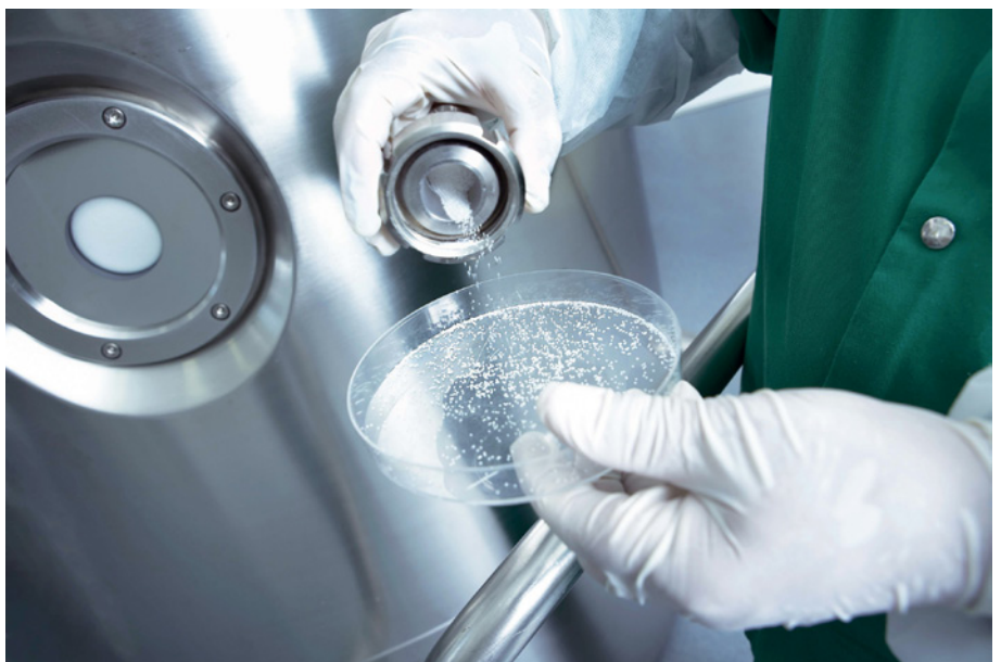
Pelletaufbau mit dem Luftgleitschichtverfahren.
