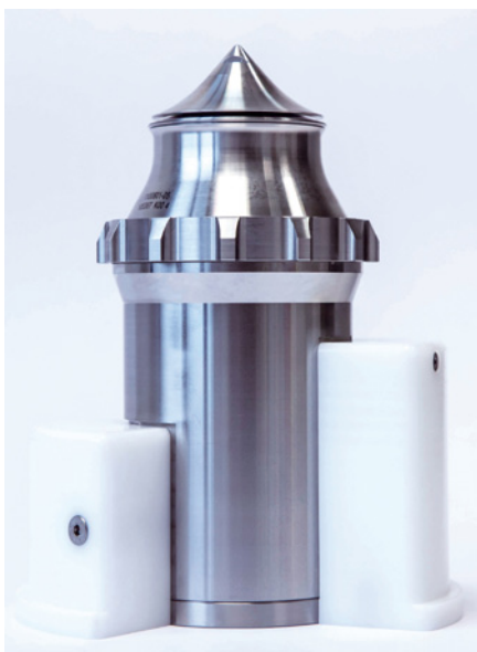
Zentral positionierte Bottom-Spray-Düse mit ringförmigem Sprühspalt.
