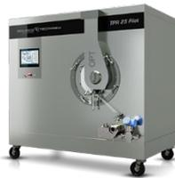
3. Wirbelschichtprozessor VENTILUS® Lab von Romaco Innojet
