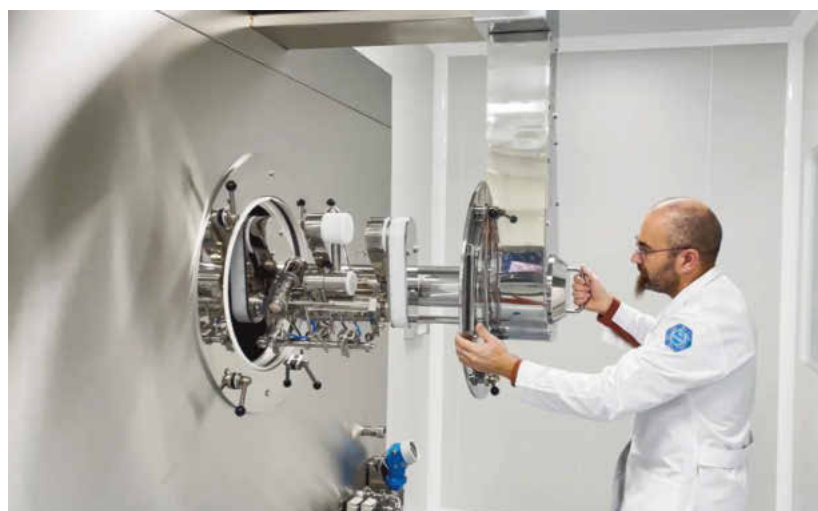
Die automatische Anpassung der Suspensionsauftragung und -trocknung im Tablettencoater ermöglichen einen effizienten Coatingprozess
