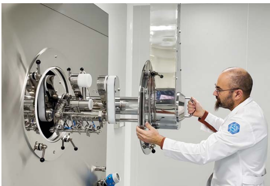
3. Powlekarzka tabletek TPR Optima od Romaco Tecpharm tworzy w pełni odtwarzalny proces powlekania.
