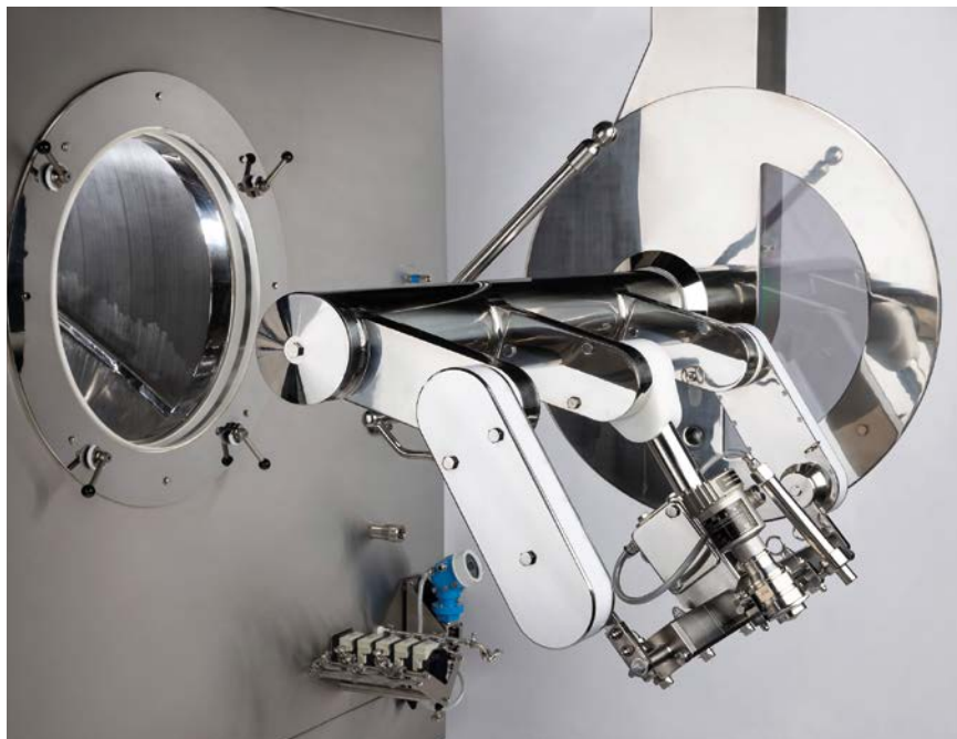
4. Rozszerzane automatycznie ramię natryskowe z automatycznie dostosowującymi się dyszami natryskowymi umożliwiają różne rozmiary partii produkcyjnej od 10 do 100%.
