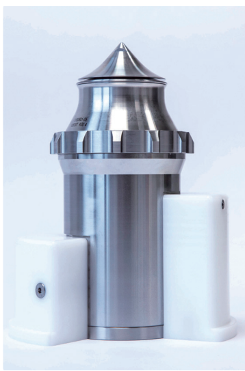
中央 ROTOJET® 喷嘴可以使颗粒堆积得非常均匀,从而避免堵塞
