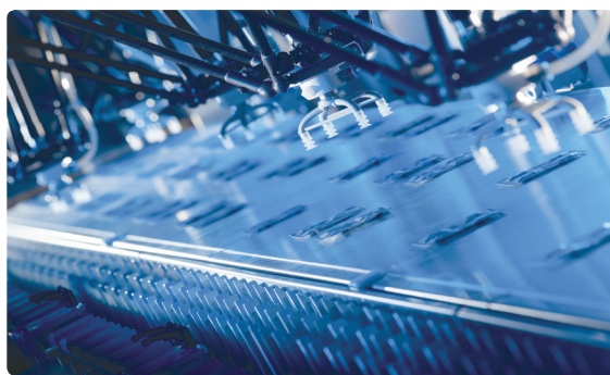
条状包装传送装置 Siebler FlexTrans 每分钟可拣选 900 个包装
