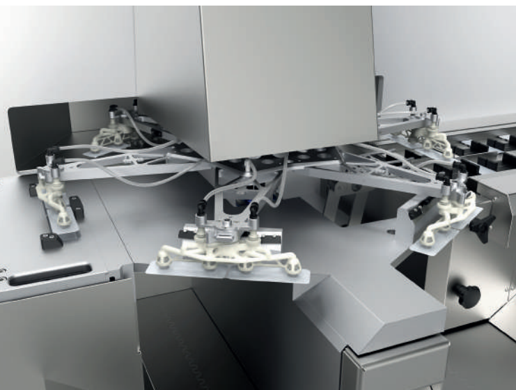
Trasferimento blister con l'encoder di Unity 600 di Romaco Noack
