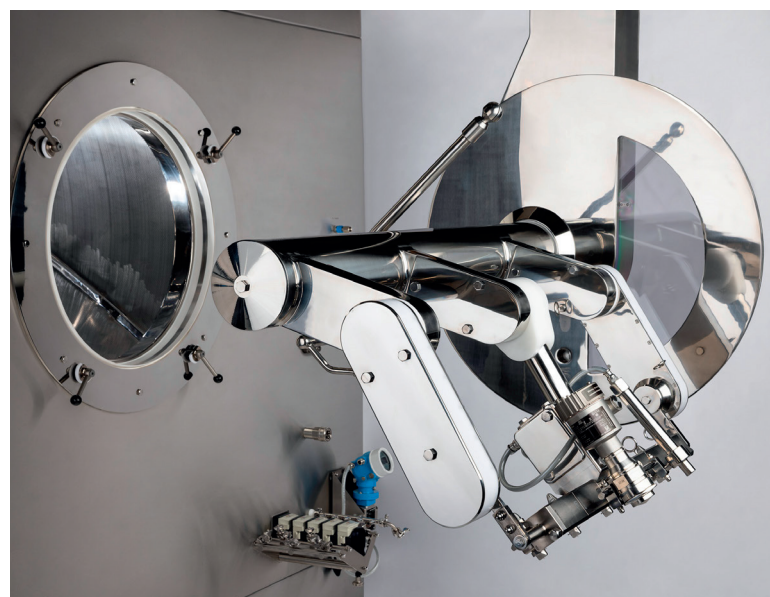
IL BRACCIO DI NEBULIZZAZIONE ESTENSIBILE AUTOMATICO CONSENTE DI LAVORARE DIMENSIONI DI LOTTO VARIABILI DAL 10 AL 100%.
