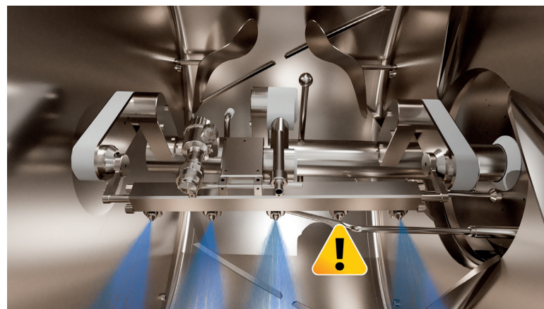
GLI UGELLI NEBULIZZATORI BLOCCATI SONO RILEVATI AUTOMATICAMENTE E PULITI SUL MOMENTO.
