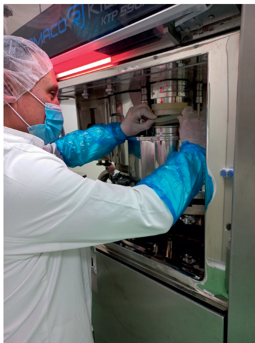
UN SOLO OPERATORE NECESSITA DI SOLI 10 O 15 MINUTI PER INSTALLARE LE PARTI INTERCAMBIABILI E IL PIATTO PORTAMATRICI.
