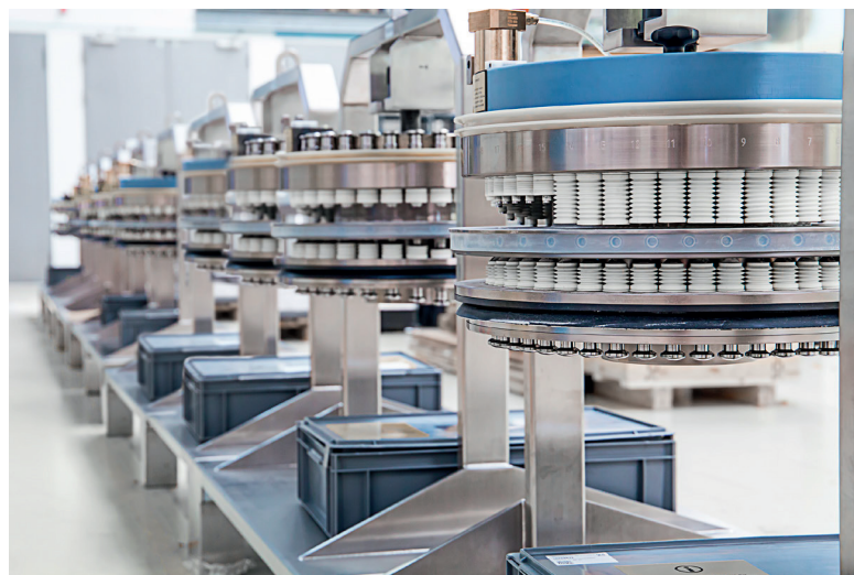
L'UTILIZZO DI PIATTI PORTAMATRICI INTERCAMBIABILI CONTRIBUISCE A OTTIMIZZARE L'OEE E IL TCO DI UNA COMPRIMITRICE.
