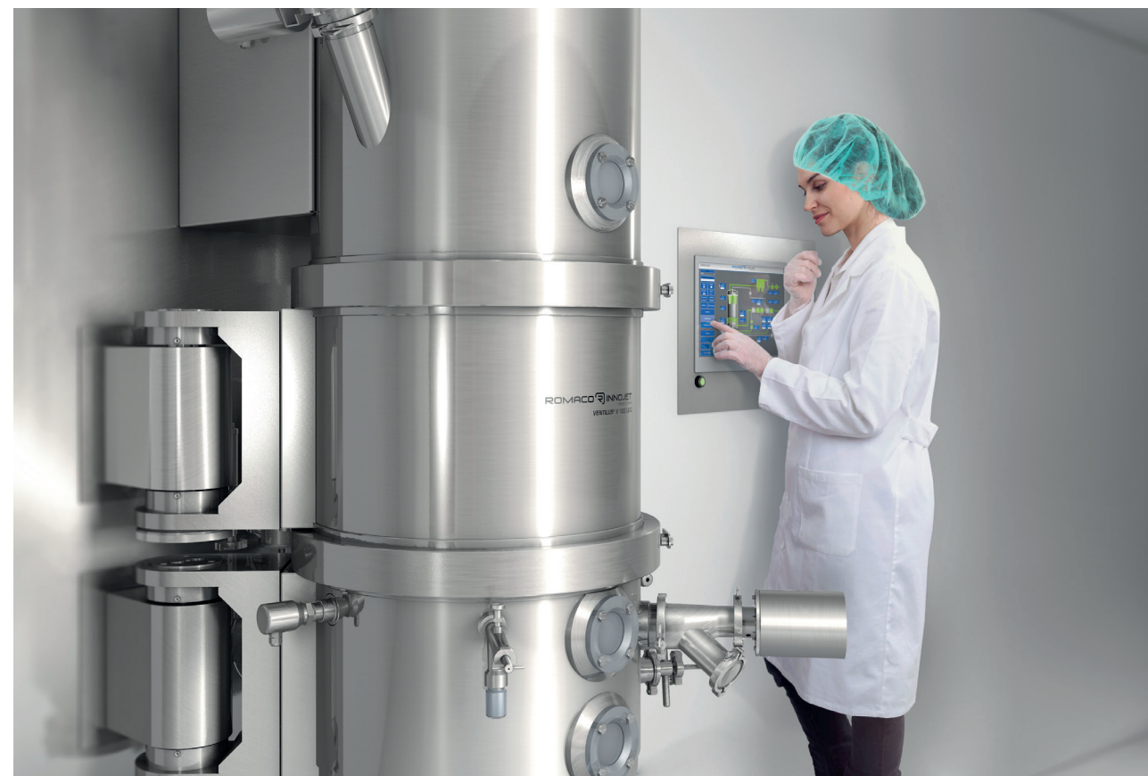
1. Efektywna, wysokiej jakości produkcja mikropeletek MUPS z użyciem procesorów fluidalnych serii VENTILUS® od Romaco Innojet.
