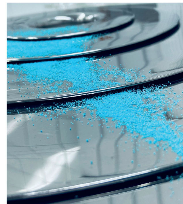
2. Dno pojemników ORBITER® od Romaco Innojet zapewnia kontrolowany ruch powietrza procesowego, w którym peletki ezomeprazolu nie są wystawione na naprężenia mechaniczne.
