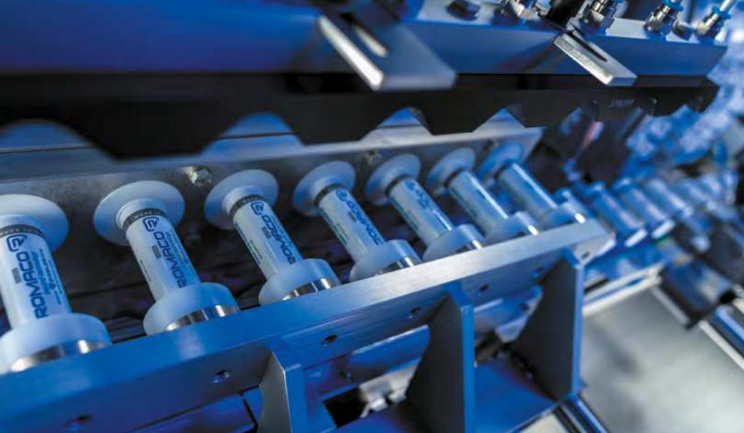
Für die schonende Abfüllung von Brausetabletten sorgt bei der Röhrenfüllmaschine STF 120 das Rotationsverfahren.
