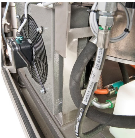
Kühleinrichtung Siemens Torque-Antrieb
