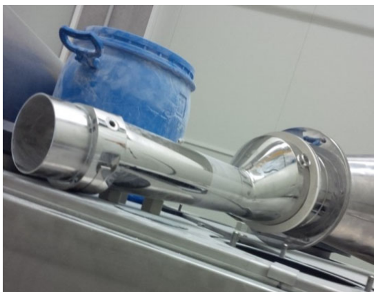
Konischer Fülltrichter für besseren Produktfluss
