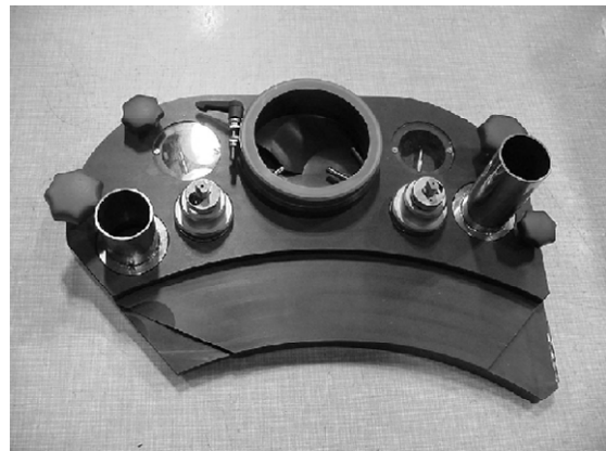
Füllschuh mit Schornsteinen für bessere Entlüftung
